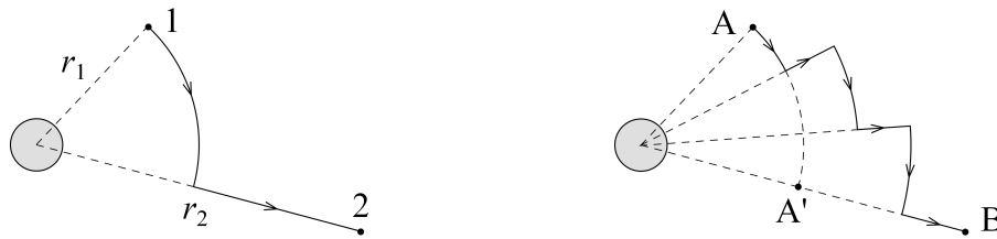
(a) Munkavégzés csak radiális elmozduláskor (b) Felbontás radiális és tangenciális szakaszokra történik
