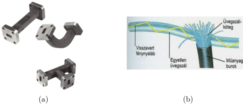
9.14. ábra. Csatorna hullámvezető mikrohullámú tartományra (a), illetve üvegszál (b) látható vagy infravörös fényre
