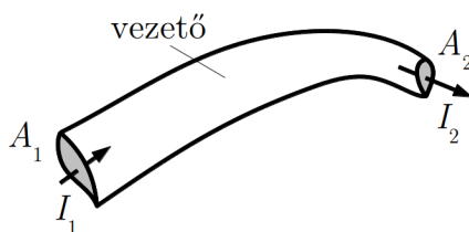
3.26. ábra. A töltésmegmaradás egy vezető szakasz térfogatában
