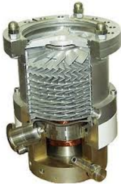
2.1. ábra. A turbomolekuláris szivattyú felépítése.
