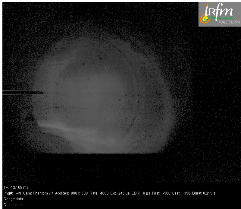
2.19. ábra. Egy erős módus leállítja a plazma forgását és diszrupciót okoz a Tora Supra tokamakban. A video megtekinthető a jegyzet online változatában.
