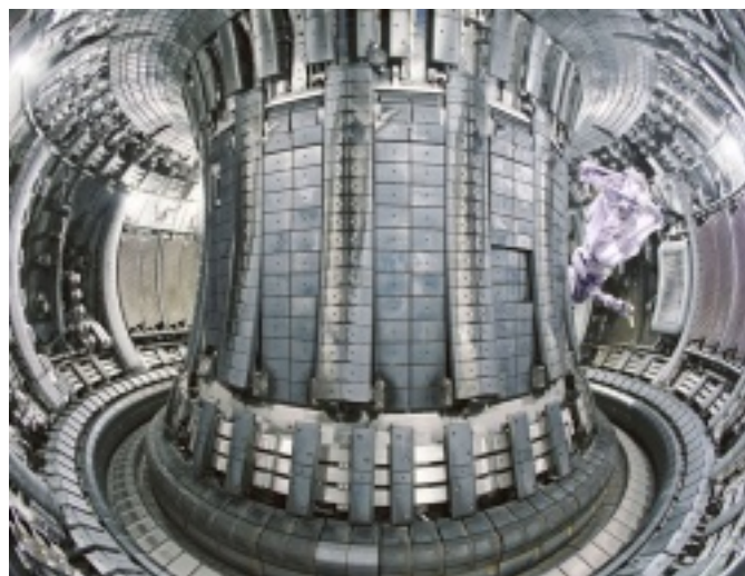
2.3. ábra. A JET tokamak vákuumkamrája.
