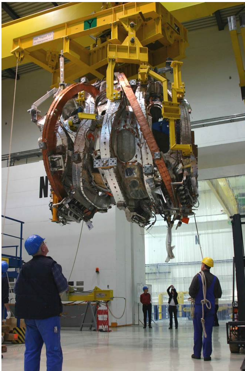
4.6. ábra. A Wendelstein 7-X sztellarátor egy fél modulja a tekercsekkel. Egy félmodulban 4 moduláris és 2 réz síktekeres található.
