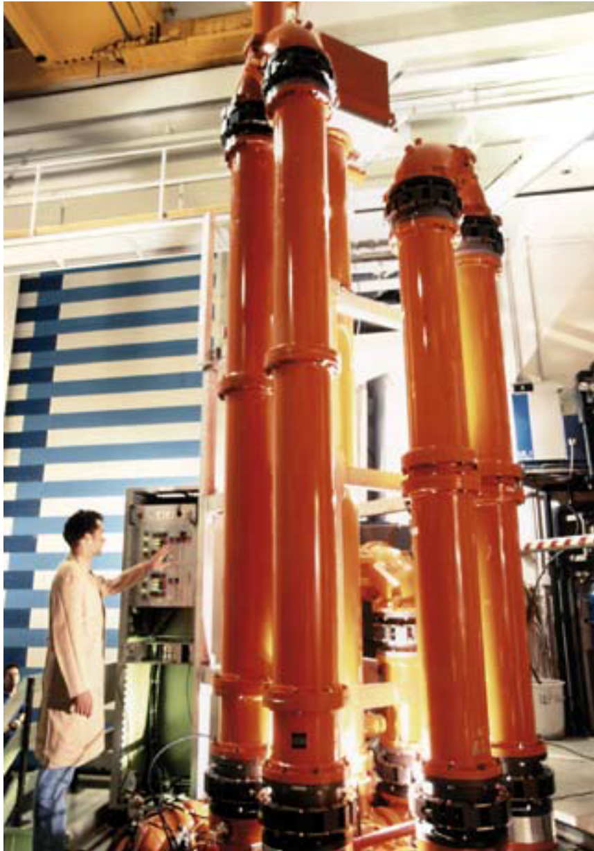
2.7. ábra. ICRH hullámvezetők az ASDEX Upgrade tokamaknál.
