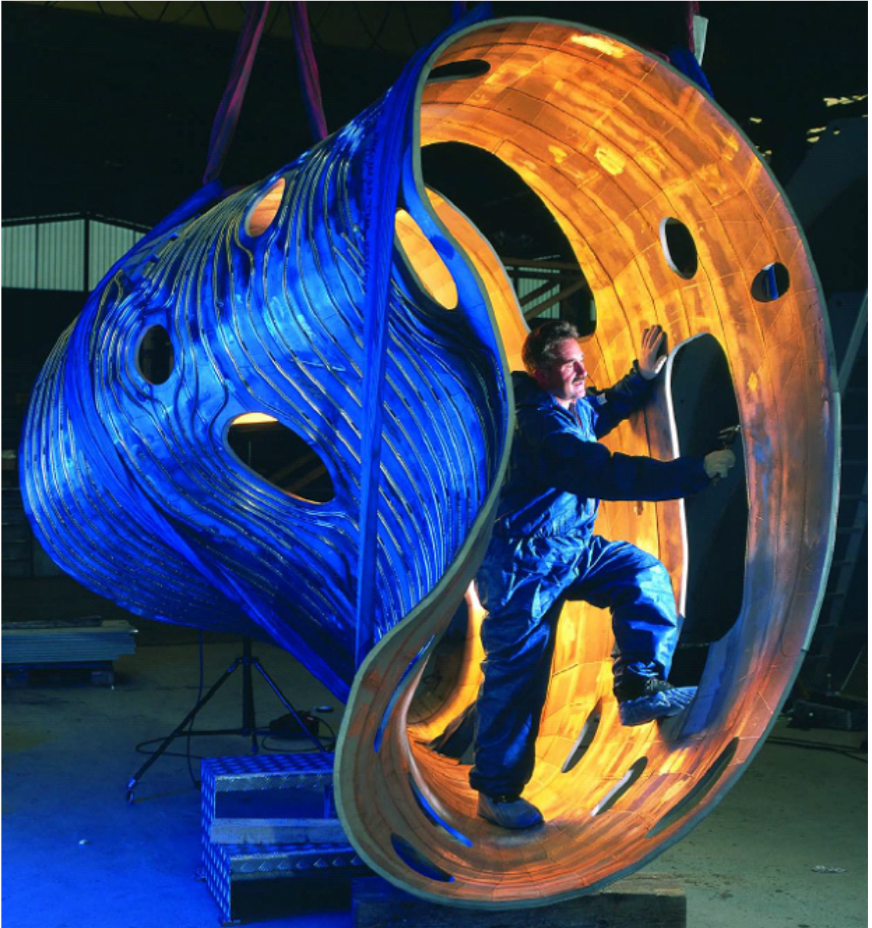
4.4. ábra. A Wendelstein 7-X sztellarátor vákuumkamrájának egy félmodulja.
