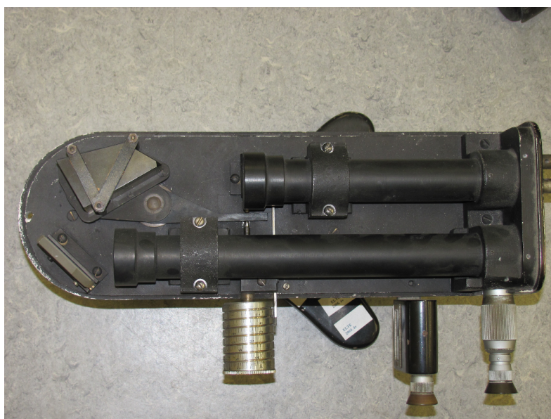
5.6. ábra. Török-Barabás-féle TB-2 típusú spektroszkóp belső szerkezeti képe
