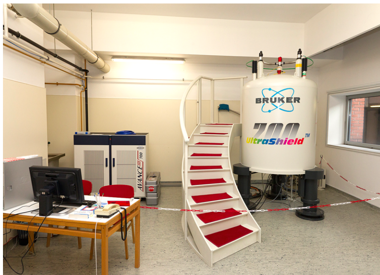
5.57. ábra. Az ELTE TTK szupravezető mágnesekkel működő 700 MHz-es NMR berendezése
