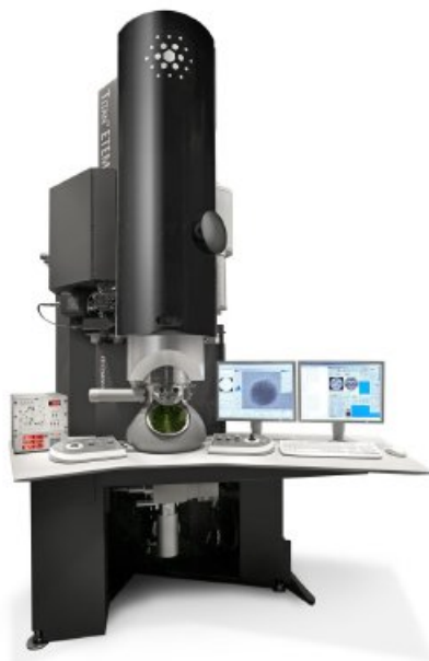
4.22. ábra. A FEI cég Titan transzmissziós elektronmikroszkópja
