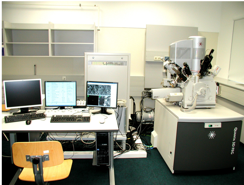
4.38. ábra. Az ELTE TTK Quanta 3D kétsugaras pásztázó elektronmikroszkópja
