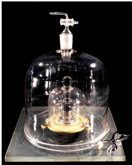
1.3. ábra. Az őskilogramm Pt-Ir ötvözetből készült henger
