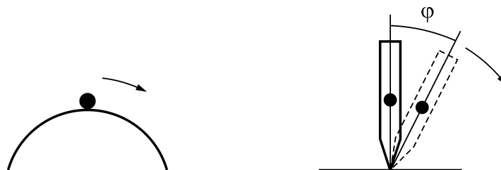
1.3. ábra. Az instabil állapot a domború felület tetejére helyezett golyó és a hegyére állított ceruza példájában. Csak egy pontban lehetséges nyugalmi állapot, amitől bármilyen kis kimozdítás után a test gyorsulva távolodni kezd.
