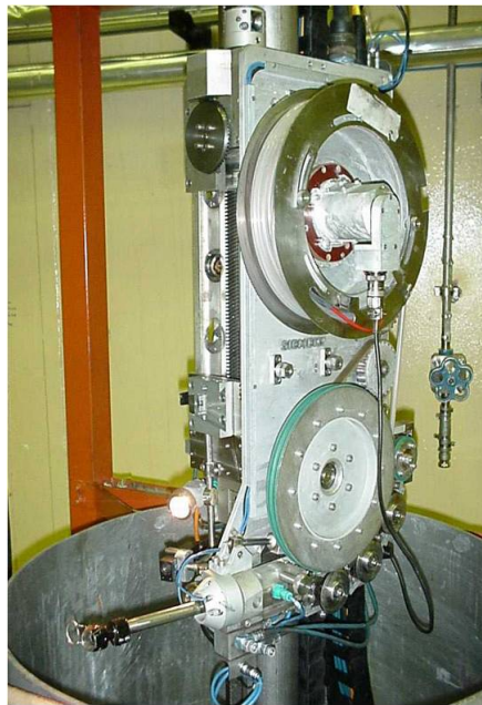
6.31. ábra. Kraftwerk Union gyártmányú feltét (support). Baloldalt látható a vízszintes helyzetű szondabevezető és referencia cső. A support árboca lehetővé teszi a vezérelt függőleges és a poláris mozgásokat
