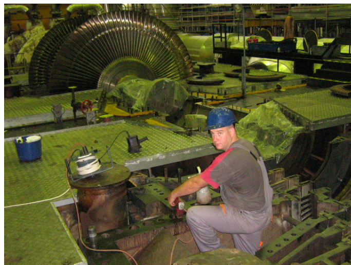
6.17. ábra. A Paksi Atomerőmű egyik turbinaházának mágnesezhető poros vizsgálata: 2013 őszéig szerencsére nem találtak indikációt [ Bacsikai P. foto 2 ]
