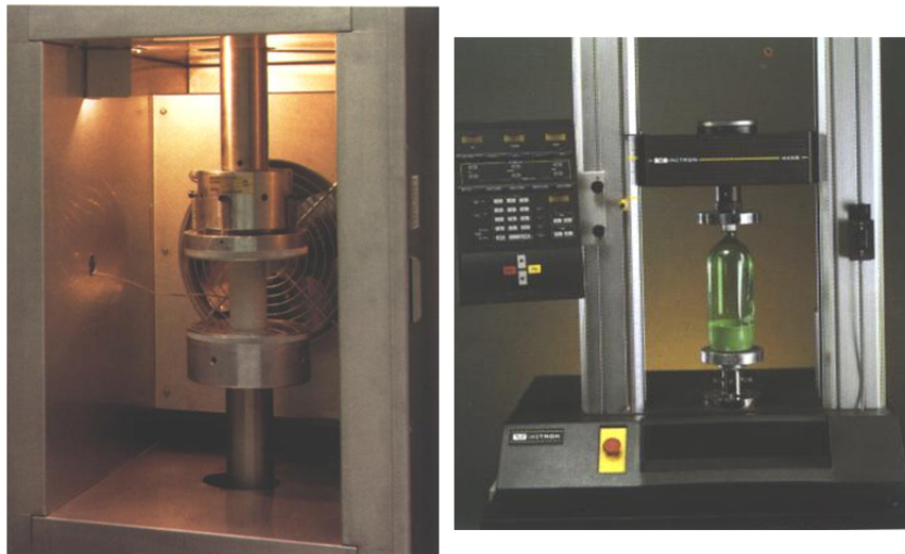
4.10. ábra. Példák a nyomóvizsgálatra: a, Kő, korrozív környezetben, b, a PET palack nyomóvizsgálata, [Csizmazia2]
