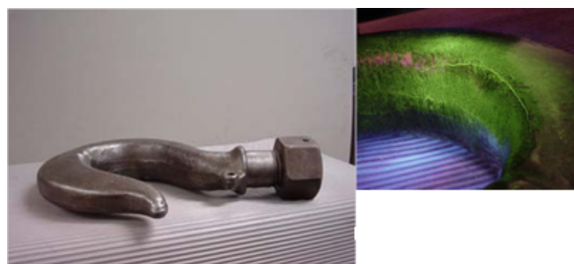
5.12. ábra. Daru horgának repedése [NDT web]
