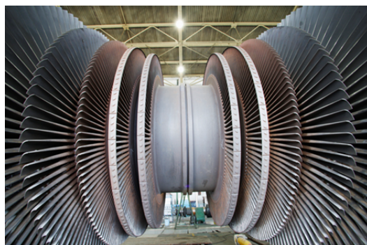
7.3. ábra. Karbantartásra kiemelt turbina forgórész lapátsorok [Bacsikai P. foto 2]
