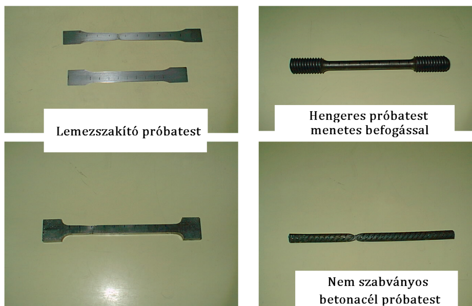
4.4. ábra. Terheletlen és elszakított szakító próbatestek [Csizmazia2]
