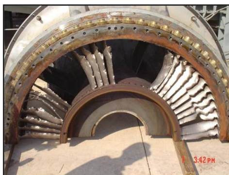
6.40. ábra. Egy turbina károsodott lapátozata, amelybe egy papírtörő gurigája került [PA foto]
