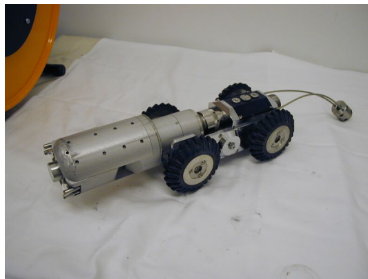
6.9. ábra. Távvezérelt, önjáró kamera. Beépített világítás, forog, billen, zoomol [Bacsikai P. foto]
