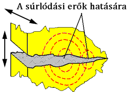
5.29. ábra. A súrlódás az anyagon belül is akusztikus eseményt kelt [NDT web]
