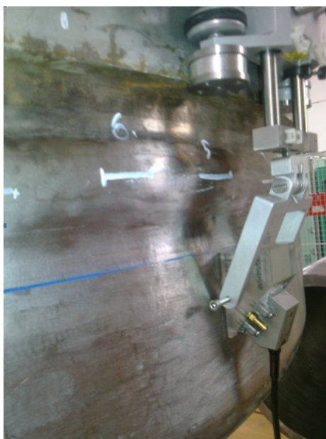
6.24. ábra. Fázisvezérelt ultrahangos vizsgálófej és a tartályvizsgáló manipulátor (a kép a Karbantartási Gyakorló Központban készült)
