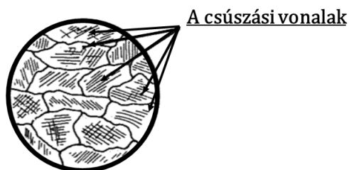
2.13. ábra. A csúszási vonalak mikroszkópos képe a kristallitokban [Csizmazia1], [Prohaszka], [Jarfas]
