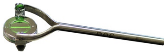
6.14. ábra. Berthold-tárcsa: figyeljük meg a zölden ragyogó indikációt [ Helling Gmbh web ]
