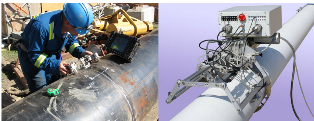
5.27. ábra. Bal oldalon: Félautomata letapogatás Omniscan-nel, főleg a kézi mozgatósi hibák kiküszöbölésére; jobb oldalon: ez az automata ultrahangos letapogató rendszer végigmegegy az épülő olajvezetékeken [ NDT web ]
