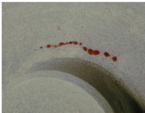
5.4. ábra. Példa penetrációs folyadékos hibajelzésre egy tárcsa tövénél [NDT web]
