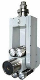
6.8. ábra. Sugárzásálló kamera: beépített világítással, forog, billen, zoomol [VISATEC Gmbh web]
